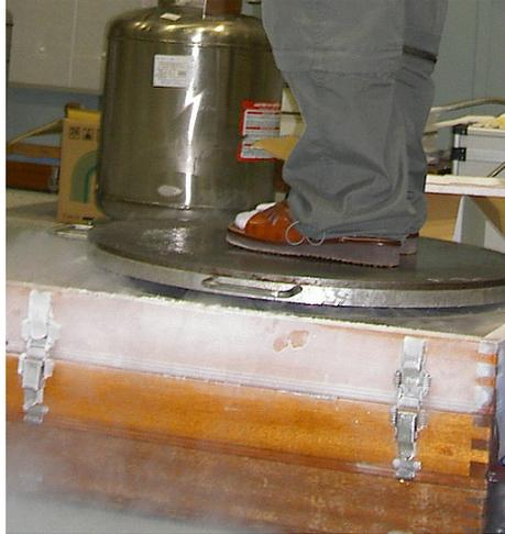
Fig.1.5 バルク超電導体による人間浮上
