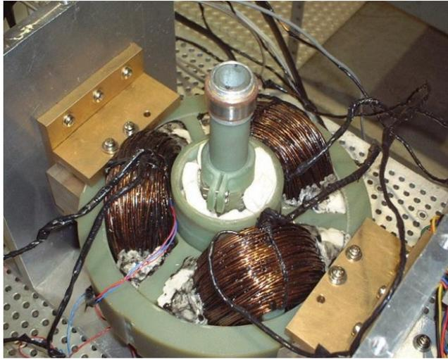
Fig.1.7 バルク超電導体を用いた小型電動機
