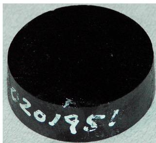
Fig.3.4 YBCO バルク超電導体試料外観
