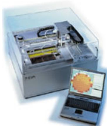
Fig.3.2 第三高調波電圧を用いた臨界電流密度分布測定装置 [17]
