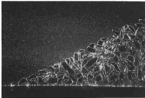
写真3 堤体模型 (粒径5~12 mm) 中央断面
