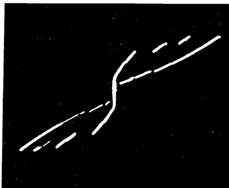
図-5 ジョセフソン効果 X : 20mV/div Y : 1mA/div
