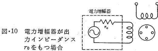
図・10 電力増幅器が出力インピーダンス $r_0$ をもつ場合
