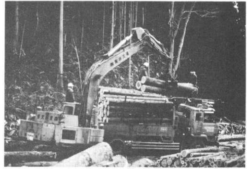
図-7 グラップルクレーンによる木材積込作業 (1987年1月 勿来宮林署管内)
