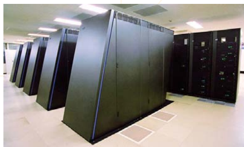
高エネルギー加速器研究機構の「IBM BlueGene Solution」。理論演算性能 57.3 テラフロップスで国内最速クラスの性能をもつ。
