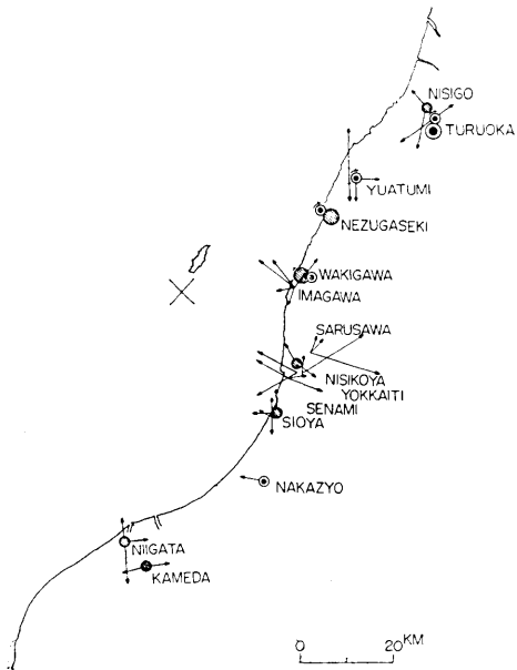
第3図 墓石および石燈籠(小さな円)の転倒と回転の方向。倒れた石燈籠が半分以下のときは円の一部分を白く残した
