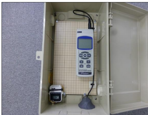
図2. 計測装置の内観 (左下:温度計, 右上:日射計)
