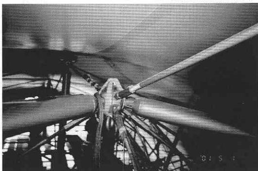
写真 5 加速度計設置状況
