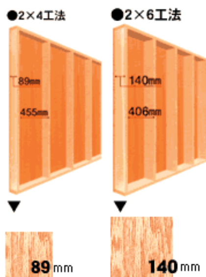
図 4.4.1 2 \times 4 工法と 2 \times 6 工法の違い
