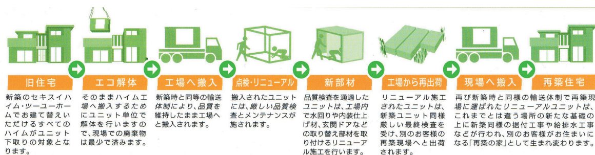
図 3.5.2 再築システムの流れ
