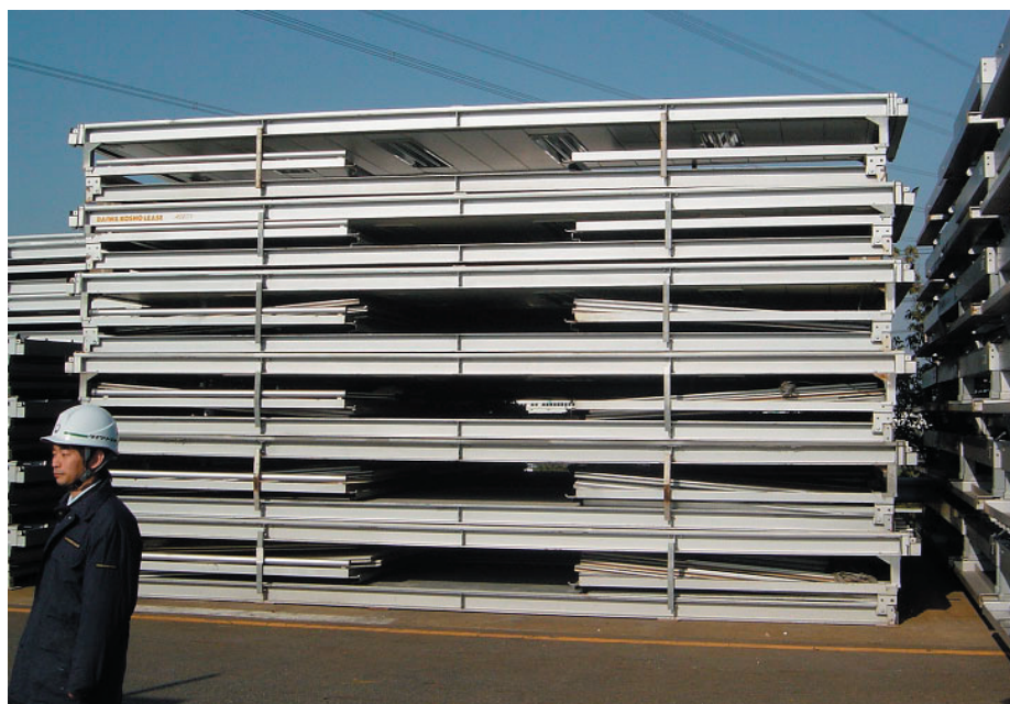
写真 3.6.3 ユニット工法製品のノックダウン式
