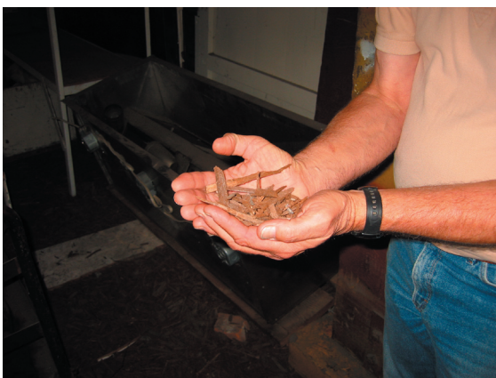
写真 4.2.10-11 構造用木材の使い道はそのまま用いるほか、チップ化し地覆材として用いる他、燃やして燃料化したり、パーティクルボードとして用いる。
