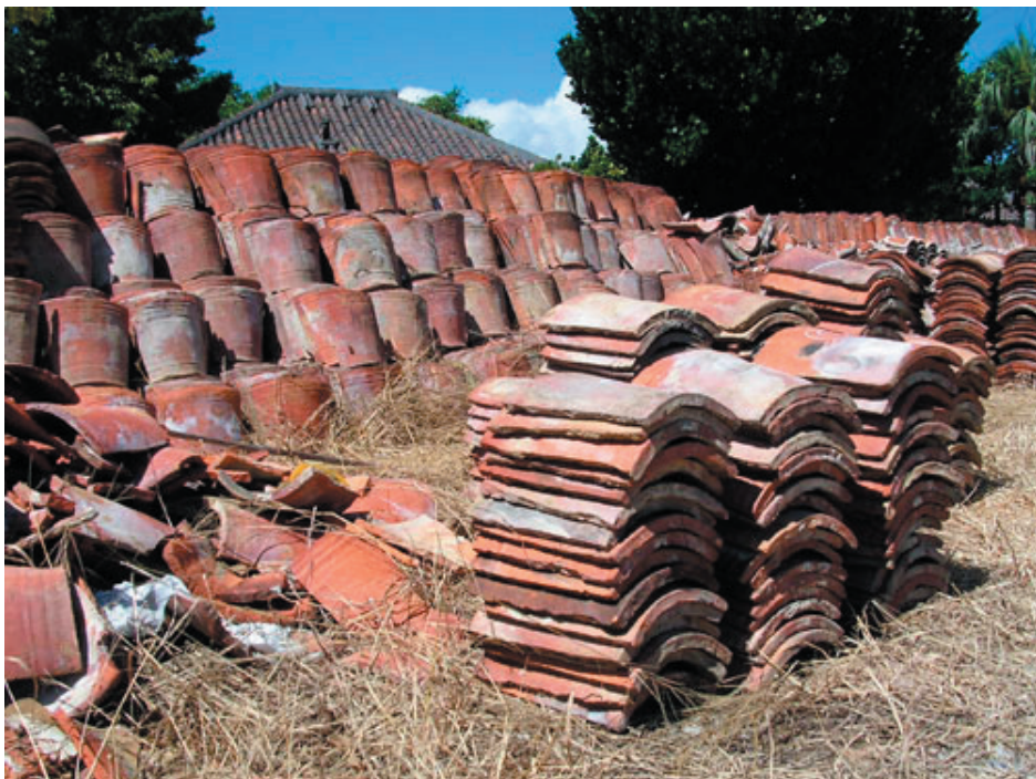
写真 3.2.4 赤瓦は漆喰を剥ぎ取り、野積みにして保管される
