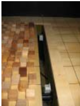
図 3.5 ロードセル設置状況
