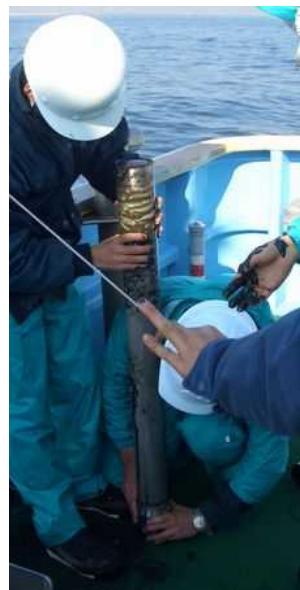
引き上げた採泥器からサンプルを外す
