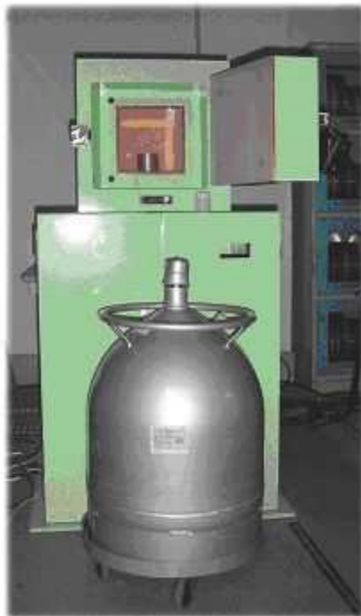
図 2-7 放射線強度測定器(米国 ORTEC 社製 GMX29PHP-Ge 検出器) 手前にある灰色の容器は測定時に必要な液体窒素を入れるものである。
