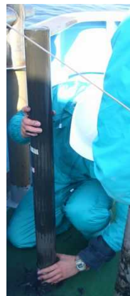
引き上げた採泥器からサンプルを外す
