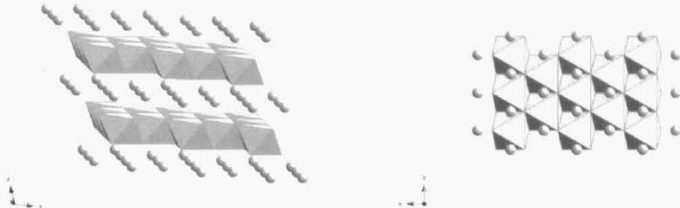
図 1.12:  $\text{NaNiO}_2$  の結晶構造.
