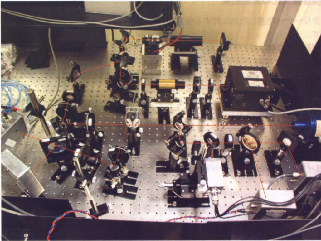
図 5.8: 実験系写真. ここでは四分分割フォトディテクタが加わっている (下部中央寄り右側).
