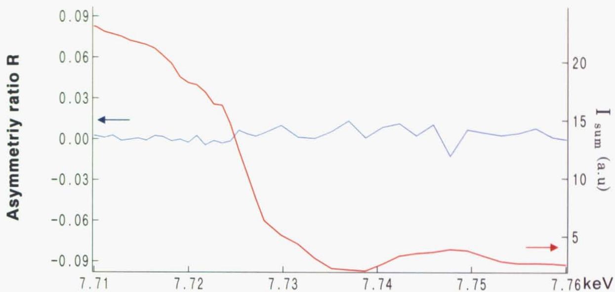
図 6.11: CoO (200) 面における、左右円偏光の散乱強度の和（赤線）と、非対称比（青線）のグラフ 検出器はシンチレーションカウンター
