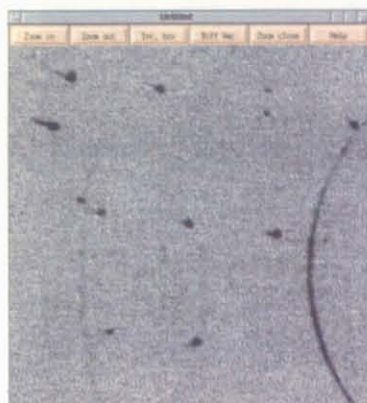
図 34: \Phi=48-54\text{deg} 振動写真 (生データ), 30min, 42kV-120mA, 293K(室温)
