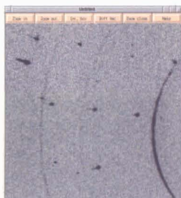
図 35: \Phi=48-54\text{deg} 振動写真 (生データ), 30min, 42kV-120mA, 100.25±0.08K
