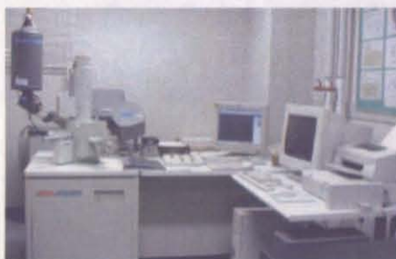
図 9: 走査電子顕微鏡・エネルギー分散型、波長分散型 X 線マイクロアナライザー (SEM-EDS,WDS) (物性研究所化学分析室 HP より引用)
