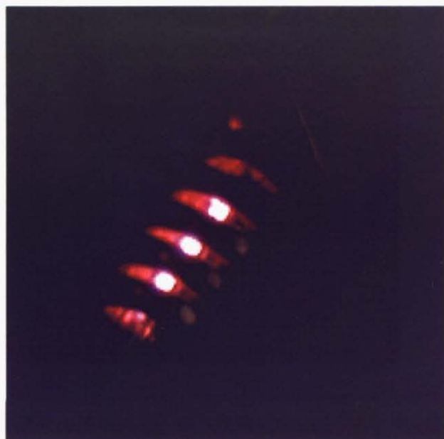
Fig.2-13 ガラス管先端径 20\ \mu\text{m} 、ガス流量 0.5\text{sccm} (プラズマ発生部圧力約 60\text{Torr} )、入力電力 0.3\text{W} での TEMP 発生の様子
