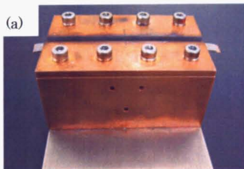
図 4.2.2 電子ビーム照射セットアップ写真 (a)短尺試料, (b)円筒試料
