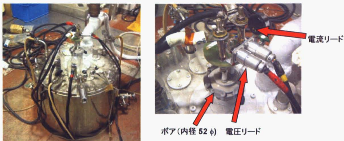
図 4.2.4 18 T 超伝導マグネット外観と試料セットアップ
