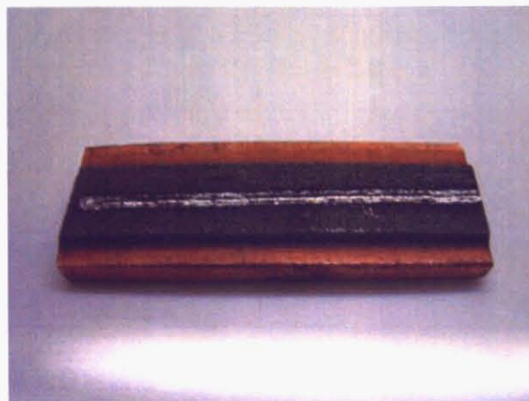
図 5.1.2 電子ビーム照射後の短尺試料 投入熱量:1000 W
