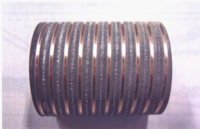
図 6.2.4 未照射部分を切削した試料
