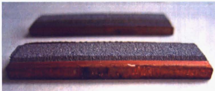
図 5.1.1 短尺 cold-spray 試料基板 (ビーム照射前) 銅基板厚み 2 mm, 膜厚 0.5mm
