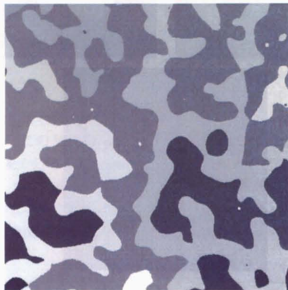
図 6.4: ラベリング処理を行った PS/PMMA ブレンドの相分離構造
