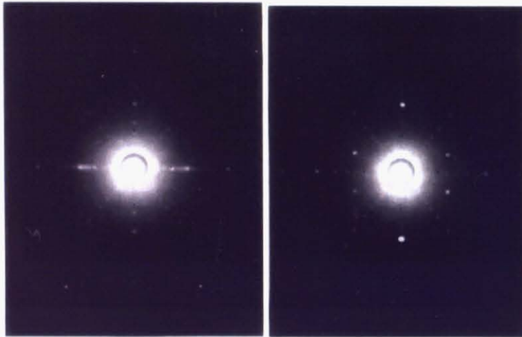
図 2.5: \text{La}_{2-x-y}\text{Eu}_y\text{Sr}_x\text{CuO}_4 単結晶の Laue 写真
