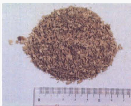
Fig.2-3-2 粉碎・混合処理後の CCA 処理木材試料
