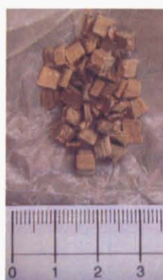
Fig.2-2-2 ニッパーで細かくした木材試料
