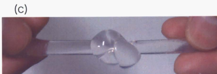
図 1.2: (a)NC ゲル, (b) 約 15 倍の延伸が可能、(c) 高い変形性。
