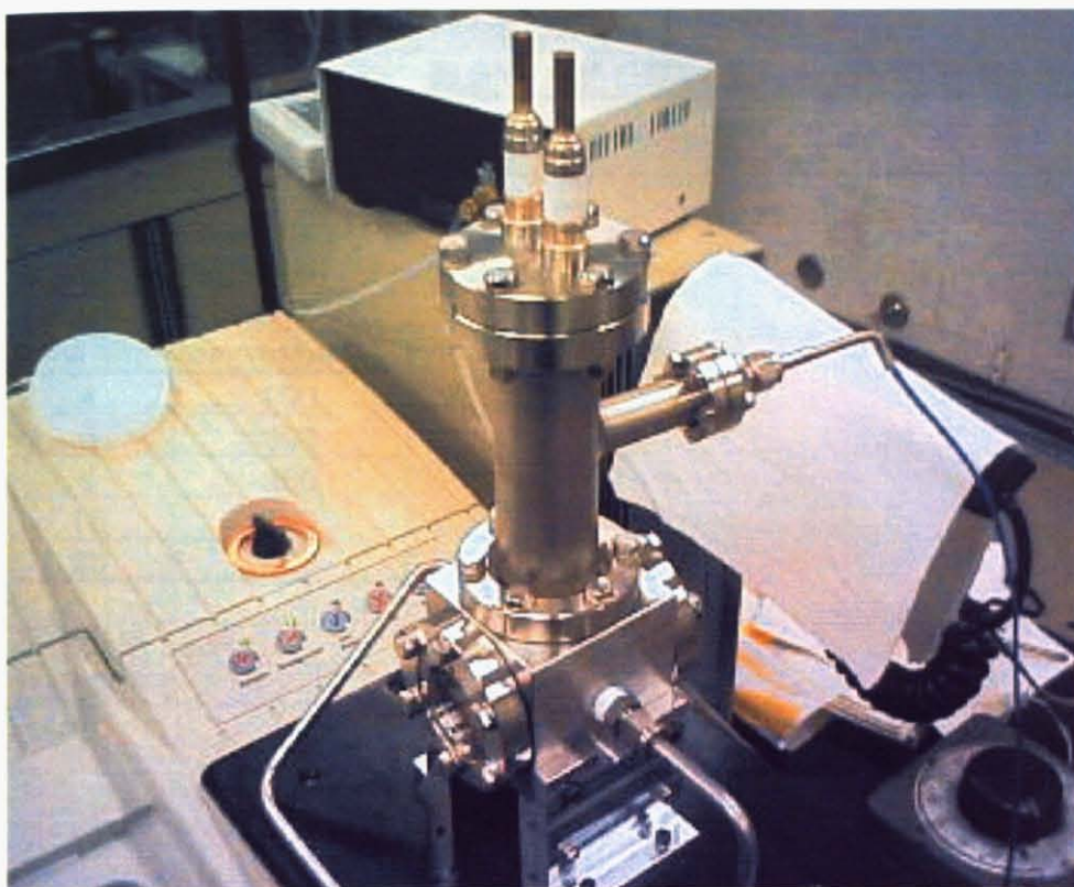
図 4.6 赤外分光分析用反応セル
