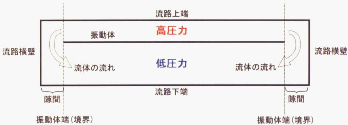
Fig.5-9 流路内部における流体の流れ
