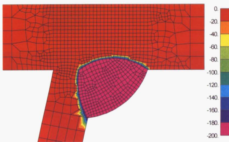
図 4.3.3 温度分布（溶接部）
