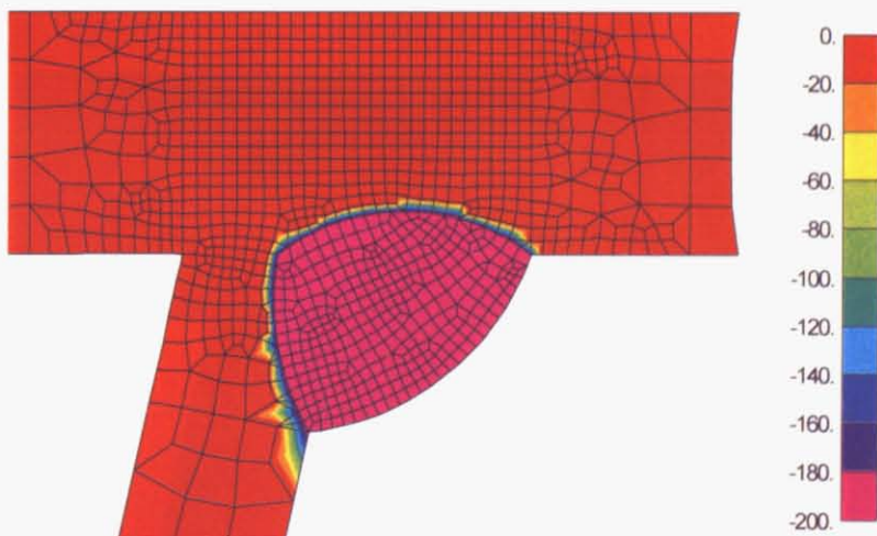
図 4.7.3 温度分布 (溶接部)
