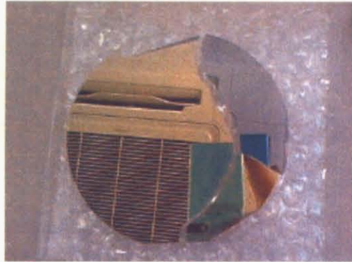
図 2.10 割れた蒸着 \text{LiNbO}_3 ウエハ
