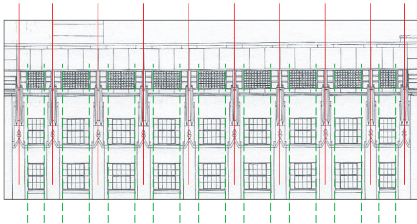
2. 既存開口部の垂直線がガラスブロック壁の縦サッシと一致 既存のリズムを強調する立面割付
