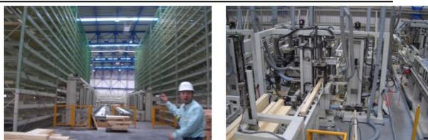
(多棟木拾装置／横架材、柱材ライン)
