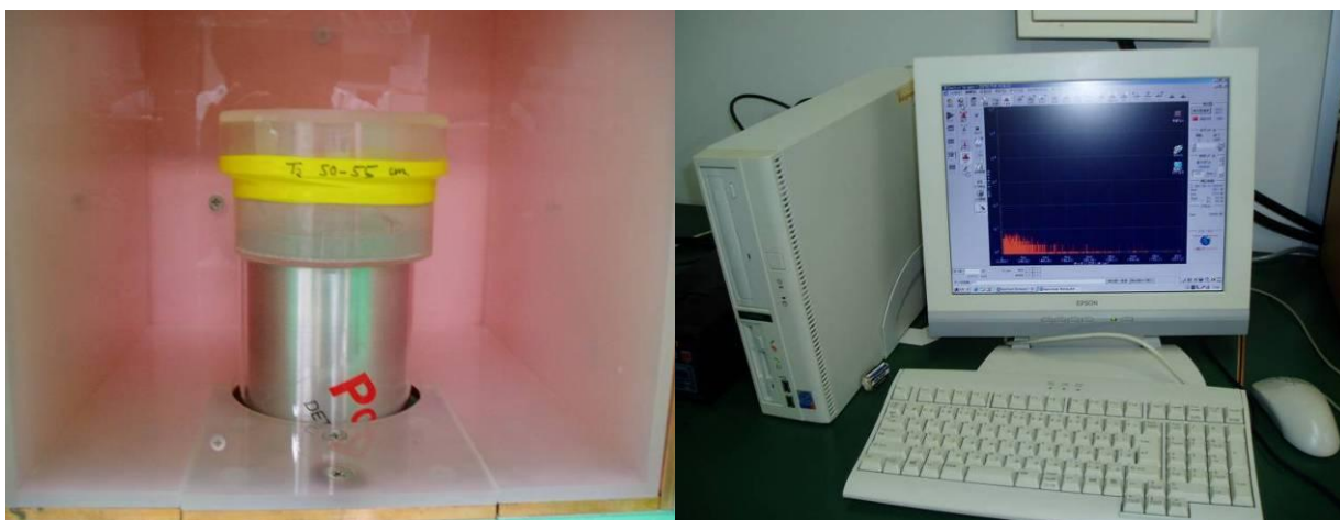
図 3-2-5 左：測定用のアクリル製容器とその中に封入された試料 右：放射線強度測定器を制御する PC
