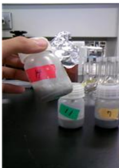
図 3-5-2 脱鉄処理を行っている様子．試薬を加えて鉄が分離させている状態．
