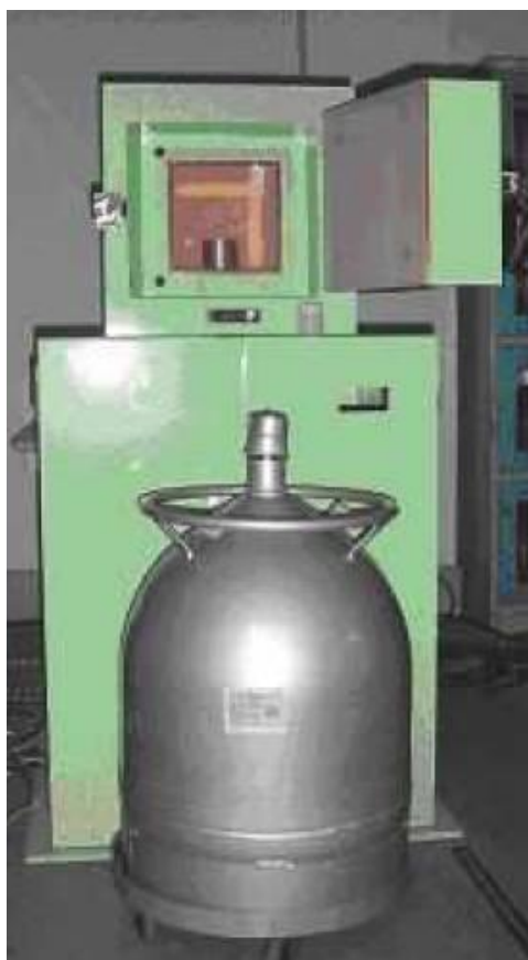
図 3-2-4 放射線強度測定器(米国 ORTEC 社製 GMX29PHP-Ge 検出器) 手前にあるグレーの容器は測定時に必要な液体窒素を入れるものである.
