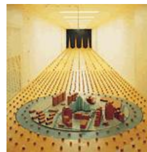
図 1.9 境界層風洞 (飛鳥建設 HP より)
