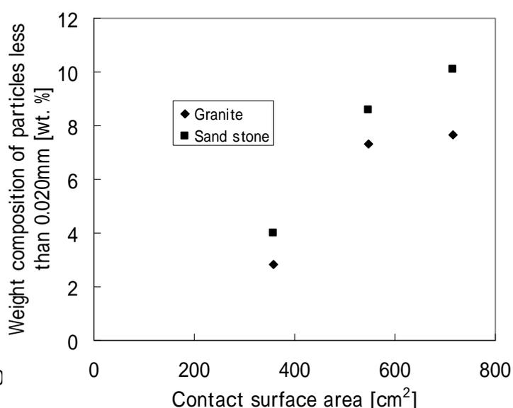
Fig.2 0.020mm 以下粒子重量組成と爆薬/岩石の接触面積との関係
