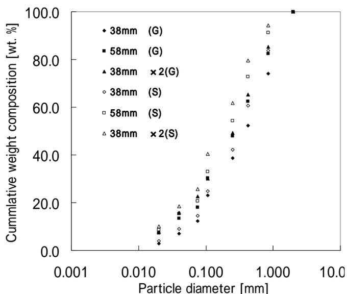
Fig.1 花崗岩/砂岩の粒径加積曲線
