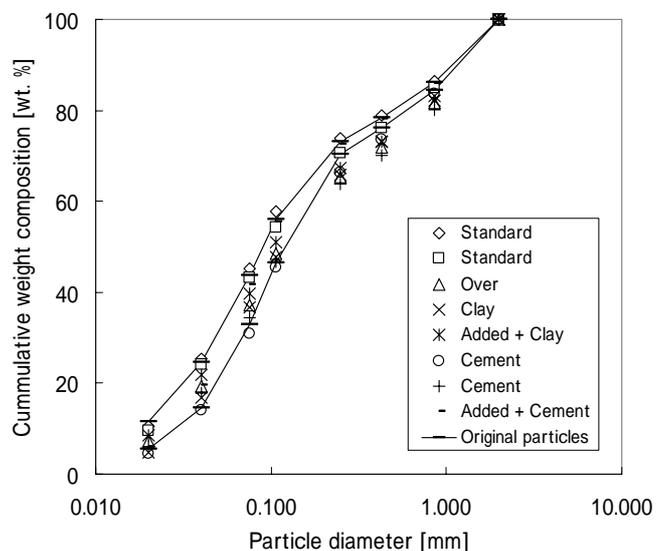
Fig.5 回収粒子/周辺粒子の粒径加積曲線
