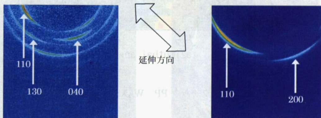
図 5.3 X線フラットパネルセンサによって撮影した広角散乱の生データ (左) PP (右) PCL/PVB ブレンド系
