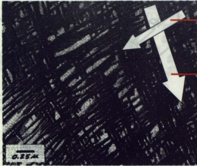
図 3.9.1 PP におけるクロスハッチ構造[12]
