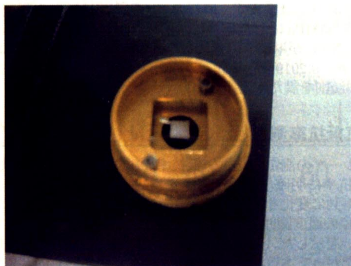
図 2.6 比熱測定用パック
