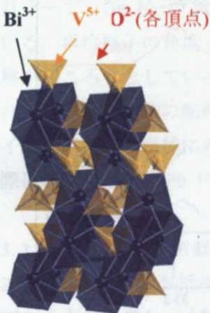
図 4-43 \text{BiVO}_4 単斜晶 結晶構造
