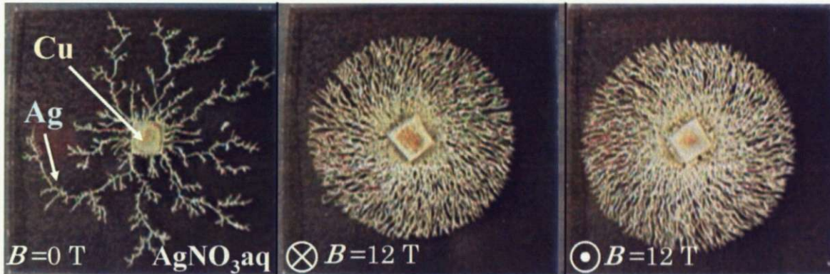
図 1.11 銀の無電解析出に対する強磁場の影響 6)
