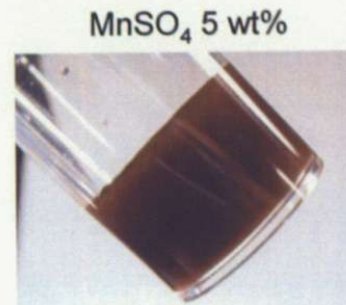
図 3.9 硫酸マンガン水溶液の固化
