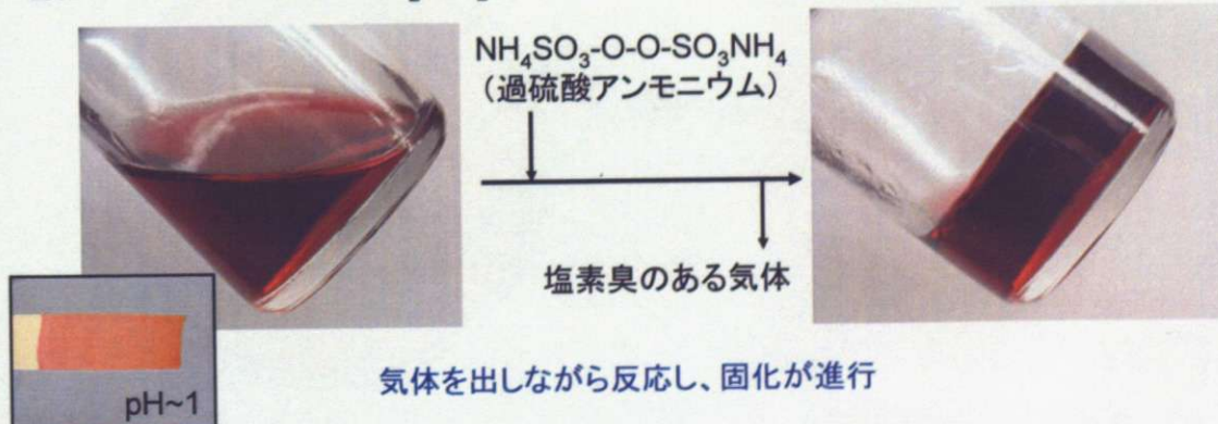
図 3.11 塩化コバルト水溶液を用いた固化実験結果
