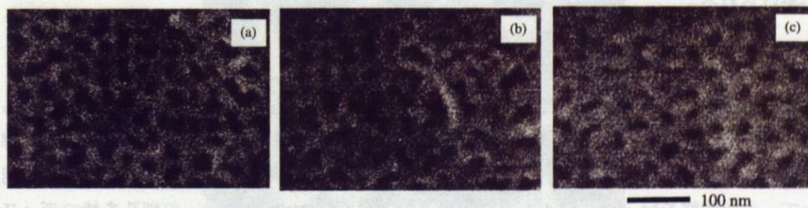
図 4.4 孔径 20 nm の細孔を持つディスクの表面図: ネットワークの厚み (a)10 nm (b)15 nm (c)20 nm (SEM 像) [23]
