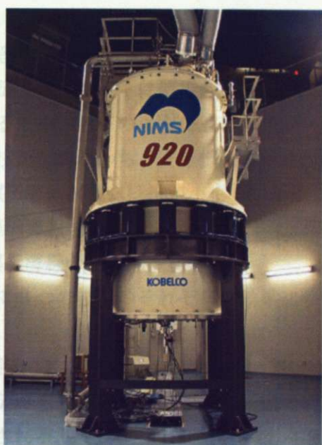
Fig. 1.2.1 : 920 MHz NMR 分光計と超伝導マグネットの磁場減衰[9]
