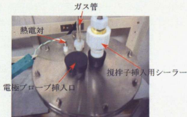
Fig. 3.3.2 : 電気炉の上部フランジ
