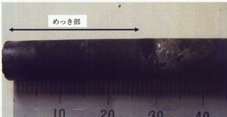
Fig. 4.3.1 : ホウ酸を塗布した純鉄円筒基板上にめっきされた膜の様子
