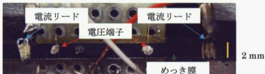
Fig. 4.2.25 : I_c 測定用に端子付けされためっき膜
