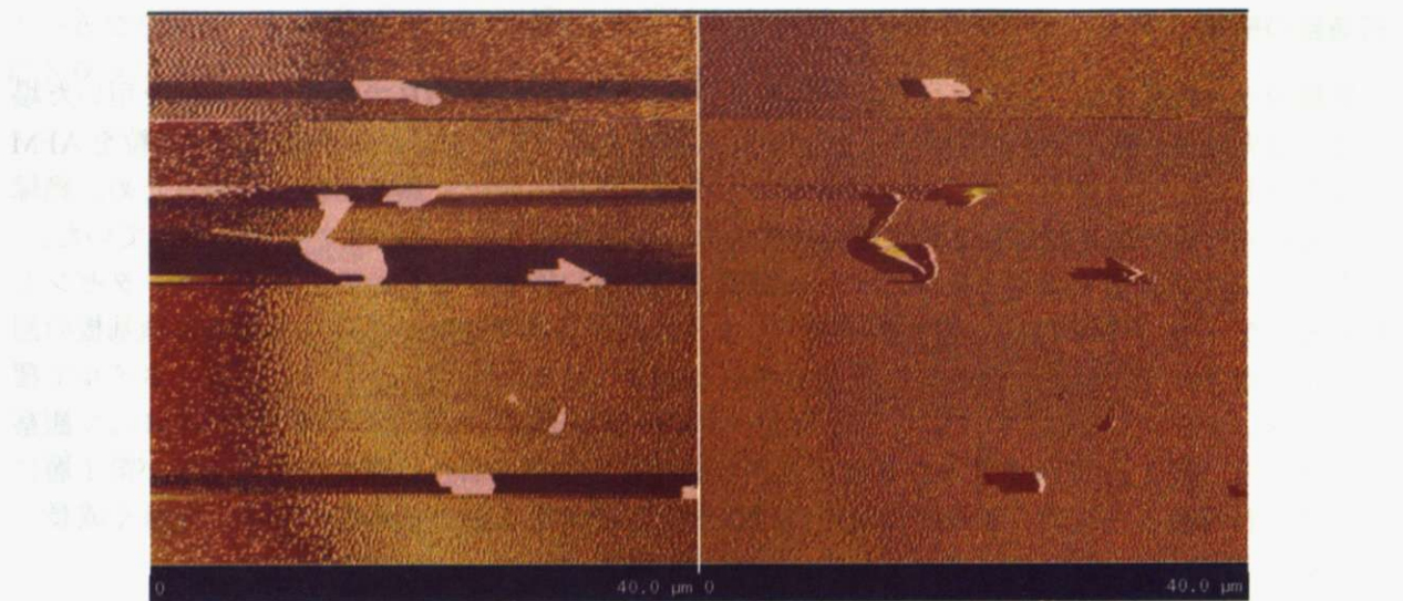
図 3.24 APS 処理を行った FET 測定用電極基板上に蒸着したペンタセンの AFM 像
