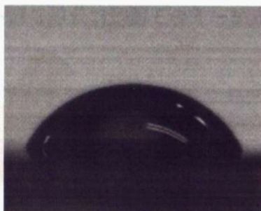
図 3.1 アセトンで表面洗浄を行った \text{SiO}_2 基板の接触角測定
