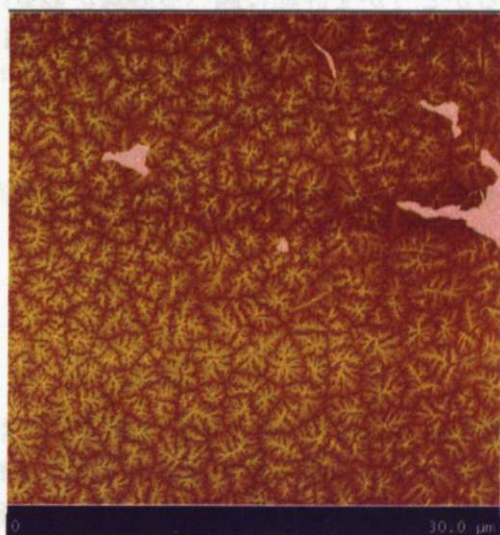
図 3.28 \text{SiO}_2 上にスパッタした Pt 上に蒸着したペンタセンの結晶粒の AFM 像 (膜厚: 15 nm)
