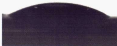
図 3.2 ピラニア溶液で表面洗浄を行った \text{SiO}_2 基板の接触角測定
