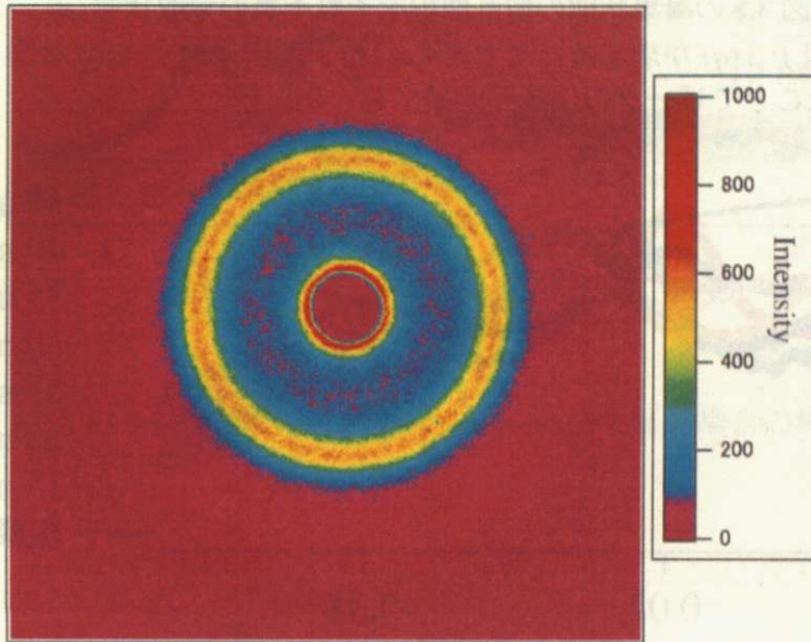
図 3.7: 凝集状態での散乱イメージ (粒径 13 nm、DNA 15 mer、完全相補鎖、NaCl 1 M)
