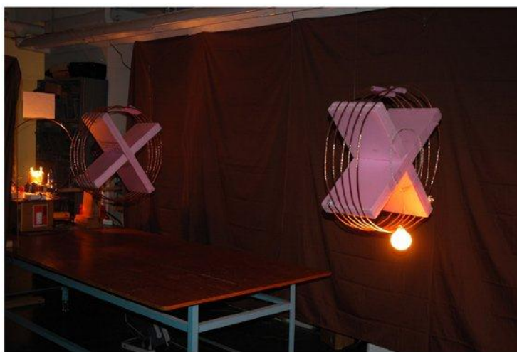
図 3.1 磁界共振結合を用いたワイヤレス電力伝送実験
