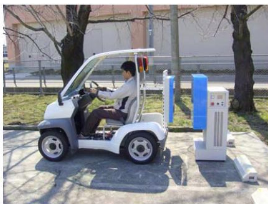
図 2.8 磁界共振結合を用いたワイヤレスによる EV への給電 (株)長野日本無線)
