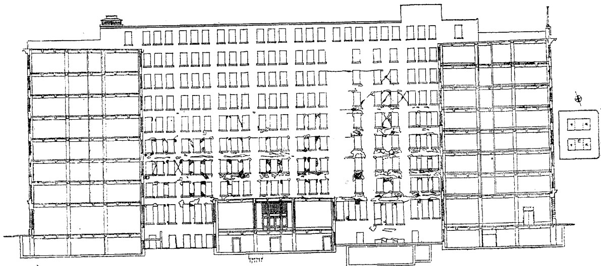
丸の内ビルディング被害調査圖
