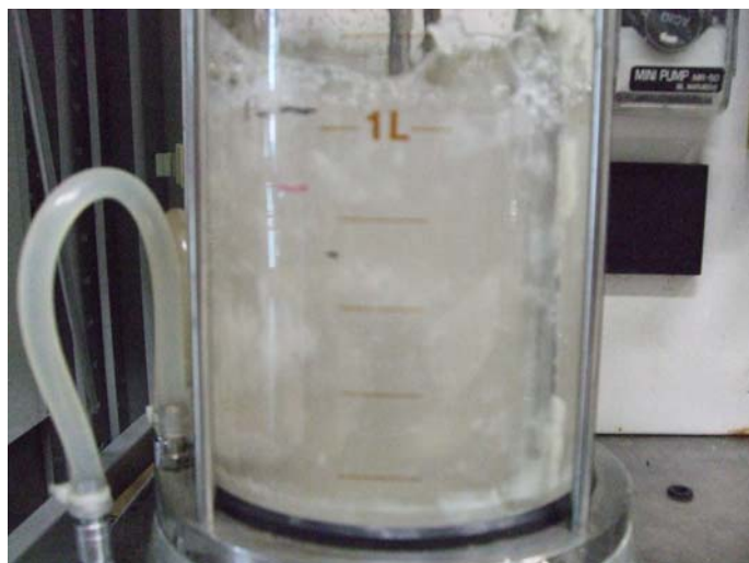
↑ 図 5-1 分散細菌槽 掃除前 (菌が壁面に付着し、 あまり懸濁していない)
