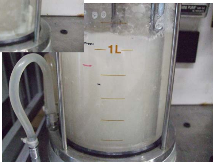
↑ 図 5-1 分散細菌槽 掃除前 (菌が壁面に付着し、 あまり懸濁していない)
