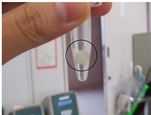
図 4-3 分散細菌槽に発生する菌塊
