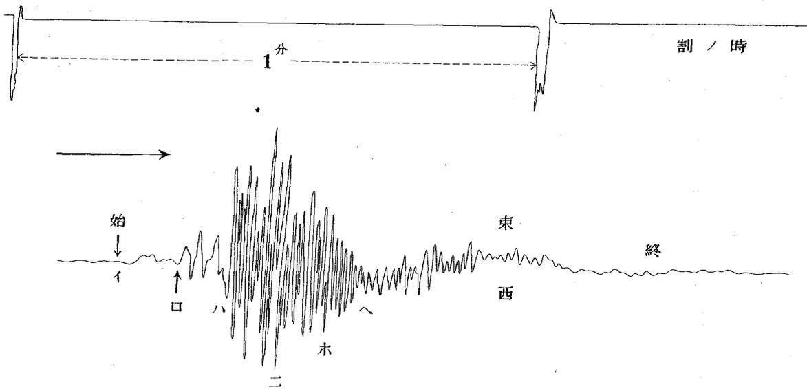
ノ時差ヲ計リテ地波ノ速度ヲ算出スルコトナセリ觀測ノ方法ハ地上ニ安置セル容器ニ水銀ヲ入レ、其水銀面ニ微動ノ現ハル、時刻ヲ「クロノメートル」ニ依リテ測ルニアリテ之ニ使用セル望遠鏡ノ視力ハ二倍ナリシガ先ヅ水銀面上ニ微動ヲ認メ其レヨリ十四、二秒時間ハ斷エス連續シテ水銀面ノ動搖ヲ示シタルガ地ノ震動ハ直接ニ身體ニハ少シモ感ズルコトヲ得ザリキ而シテ此十四、二秒時間ヲ經過シタル後ニ至リテ轟然タル一音響ヲ來シ同時ニ水銀面ハ非常ニ動搖セラレ即チ地波ト空氣波トノ到達時ノ差ハ十四、二秒ナルヲ認メ得タリ。
