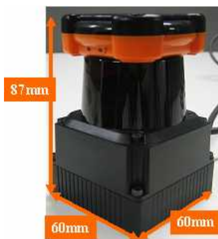
図 2.3 北陽電機社のレーザスキャナ UTM-30LX
