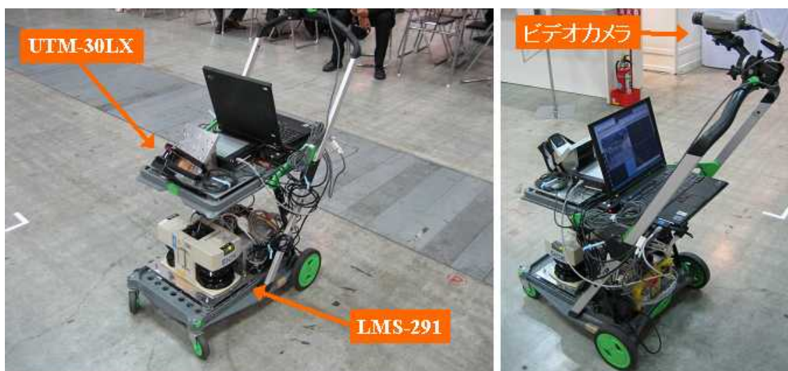
図 2.4 レーザスキャナを取り付けた状態の台車
