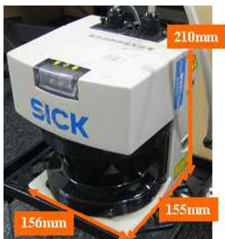
図 2.2 SICK 社のレーザスキャナ LMS-291
