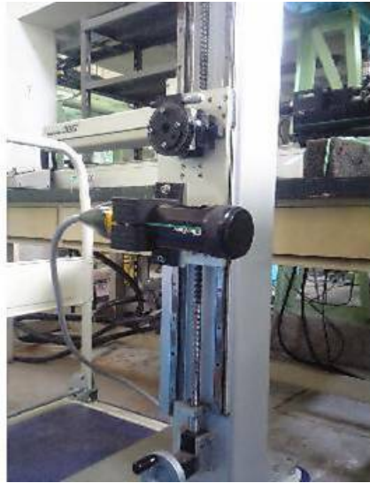
写真 2.2 LDV 計測部
