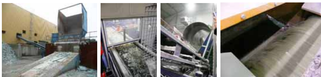
図 3-2-3：左から、ラインへの投入口、手選別、ブローワー、非鉄金属選別 46
