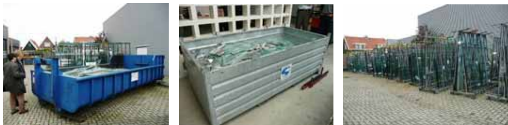
図 3-2-6：左から、回収拠点の 18 m 3 コンテナ、工場内端材用の 2 m 3 コンテナ、ストックヤード 49
