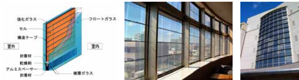
図 2-2-1：左から「複層ガラス組込みシースルーアモルファスモジュール」の詳細、内観、外観 22
