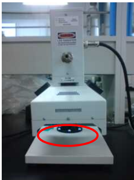
写真 4-3 クロロフィル蛍光を測定する FluorCam 赤丸の部分に、測定対象を置いて、測定をおこなう。
