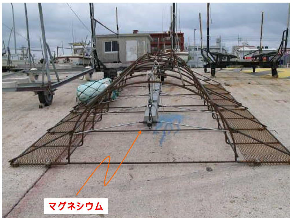
写真 3-1 サンゴを取り付ける棚（サンゴ棚）の写真
